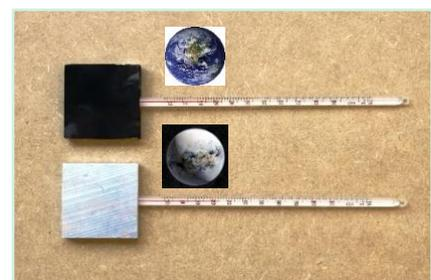
Abbildung 19 – Experiment zur Messung der Albedo
